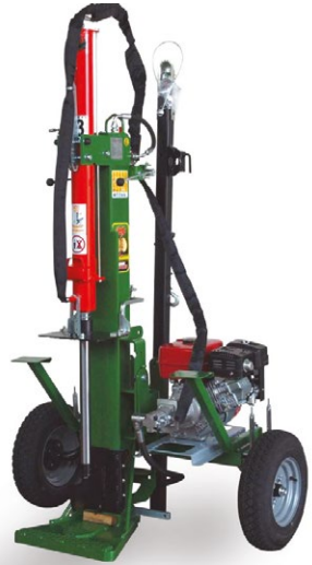
13 tonne Farmer Multiuse - 9Hp Subaru engine - 37.M.VS.10.PD
